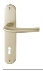
N° d'article 3230338 Code EAN 4012789467604 Pays d'origine Italie Code NC 83024110 Epaisseur de porte 40-46 mm Epaisseur du carré 7 mm Epaisseur du carré pour WC Longueur du carré clé L Percement 70 mm Entraxe de percement Vis vis métaux/douille Couleur F2 aluminium aspect champagne Gamme Cœur de gamme
