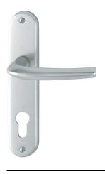
N° d'article 3230354 Code EAN 4012789467628 Pays d'origine Italie Code NC 83024110 Epaisseur de porte 40-46 mm Epaisseur du carré 7 mm Epaisseur du carré pour WC Longueur du carré clé I (PZ) Percement 70 mm Entraxe de percement Vis vis métaux/douille Couleur F1 aluminium aspect argent Gamme Cœur de gamme
