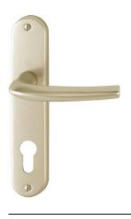
N° d'article 3230362 Code EAN 4012789467635 Pays d'origine Italie Code NC 83024110 Epaisseur de porte 40-46 mm Epaisseur du carré 7 mm Epaisseur du carré pour WC Longueur du carré clé I (PZ) Percement 70 mm Entraxe de percement Vis vis métaux/douille Couleur F2 aluminium aspect champagne Gamme Cœur de gamme
