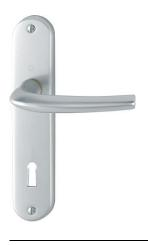
N° d'article 3230320 Code EAN 4012789467505 Pays d'origine Italie Code NC 83024110 Epaisseur de porte 40-46 mm Epaisseur du carré 7 mm Epaisseur du carré pour WC Longueur du carré clé L Percement 70 mm Entraxe de percement Vis vis métaux/douille Couleur F1 aluminium aspect argent Gamme Cœur de gamme
