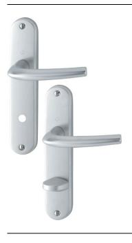
N° d'article 3230389 Code EAN 4012789467741 Pays d'origine Italie Code NC 83024110 Epaisseur de porte 40 mm 7 mm Epaisseur du carré Epaisseur du carré 6 mm pour WC Longueur du carré Percement trou de décondamnation/olive de condamnation Entraxe de perce-70 mm ment Vis vis métaux/douille Couleur F1 aluminium aspect argent Gamme Cœur de gamme
