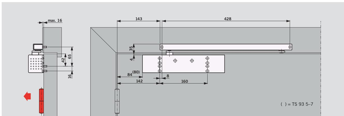
TS 93 B 2S / TS 93 B – montage sur vantail (montage normal) côté paumelles.
