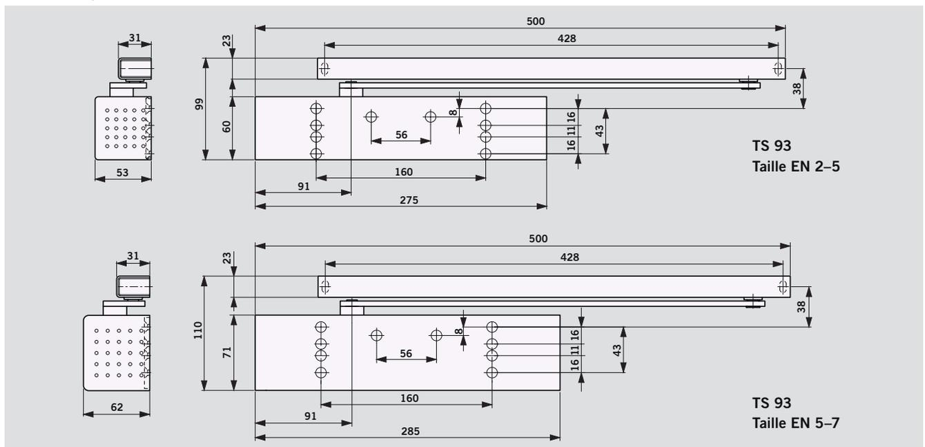
**Plaque de montage en série avec système de perçage universel.**
